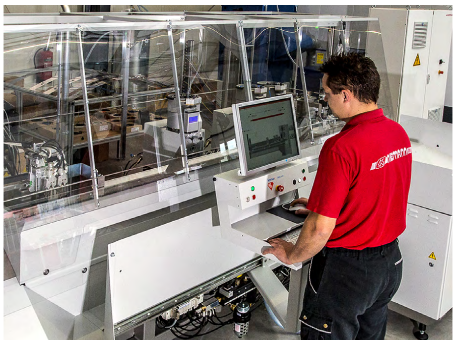
Für die Herstellung der Drähte und Drahtsätze hat die NW-Niemann GmbH in ein NC-Bearbeitungszentrum von Komax investiert – die Daten dafür kommen direkt aus dem mit der WSCAD SUITE erstellten Schrankaufbau.
