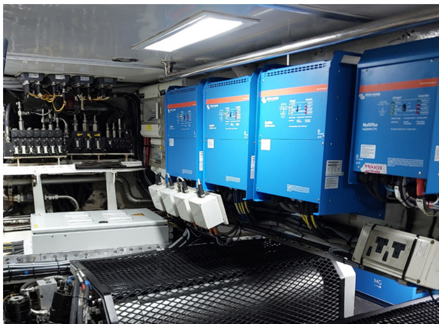
Enge Platzverhältnisse, Korrosion, Temperaturwechsel und Vibrationen in Verbindung mit nationalen Vorschriften, Brandschutzbestimmungen und Prüfverfahren der jeweiligen Klassifikationsgesellschaften erhöhen die elektrotechnischen Anforderungen im maritimen Bereich im Vergleich zu Installationen an Land
