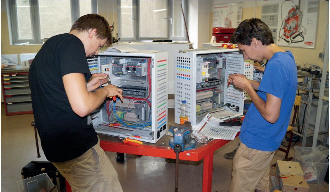
Die in der Praxis gebauten Schaltschränke werden zuvor aus den Stromlaufplänen mit der Disziplin Cabinet Engineering von WSCAD aufgebaut und geprüft.
