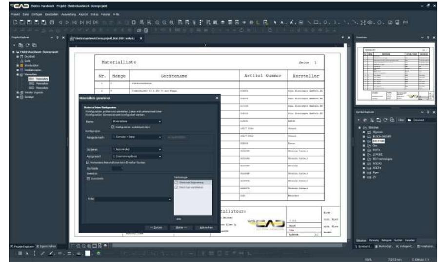
Materiallisten werden getrennt vom Installations- und Stromlaufplan erzeugt, die Ausgabe erfolgt wahlweise per Formular, als Excel-Liste oder zu anderen Kalkulationsprogrammen.
